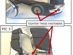
TIGHTEN THE LOCKING PIN PAD FASTENER UNDER ARM
